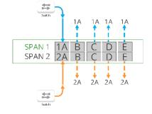
SPAN1 [1 RX / 4 TX copies] SPAN 2 [1 RX / 4 TX copies]
